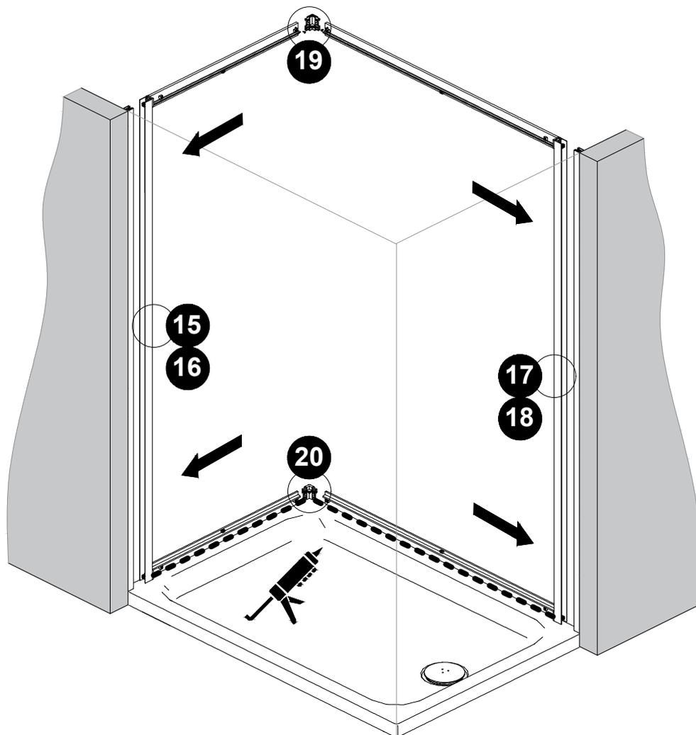
Перед сборкой нанести силиконовый герметик рис. 20 и на внешнюю сторону профиля в месте соприкосновения к поверхности
